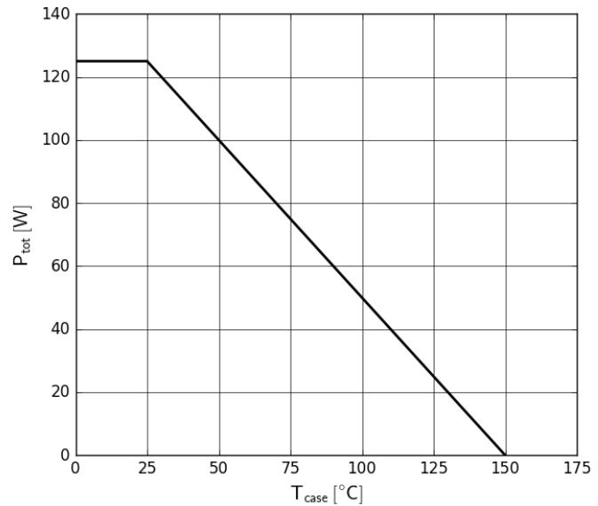
**Figure 14. Power Dissipation**
